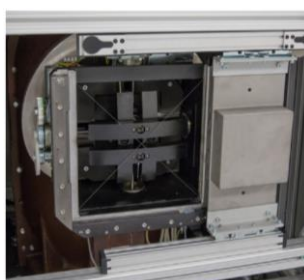
Figura nr 2 Sistemul de colimare cu lamele mobile din wolfram
