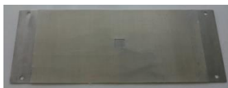
Figura 1. Sursa de suprafata cu tritium cu suprafata de 10 x 10 mm
