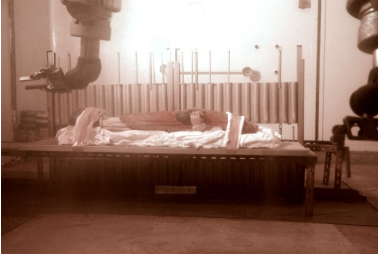
FIG. 16.4. Sculptura impregnată, în timpul expunerii la radiații pentru întărirea “in situ” a rășinii.
