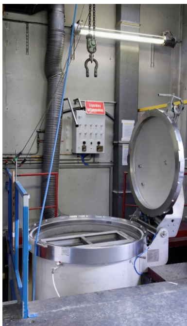
FIG. 26.4. Tancul din oțel inoxidabil pentru impregnare cu rășină.
