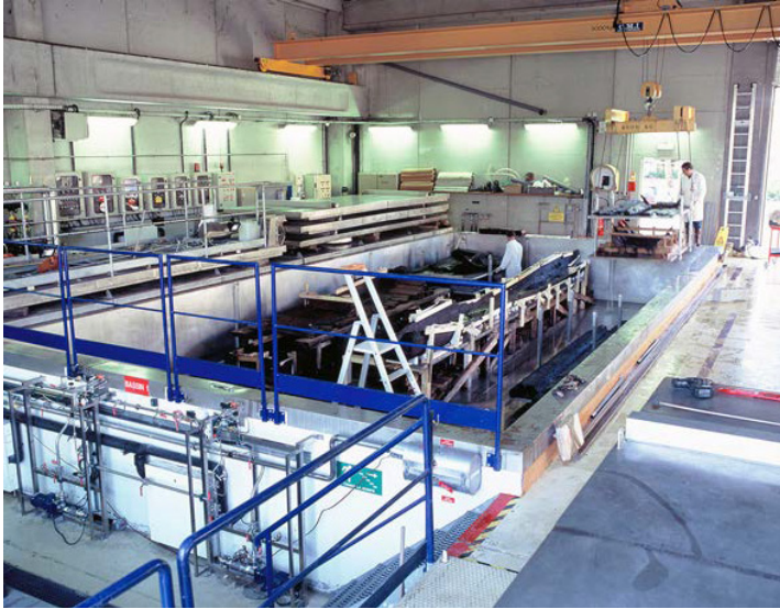
FIG. 26.3. Tancul de impregnare cu PEG (12 m × 6 m).
