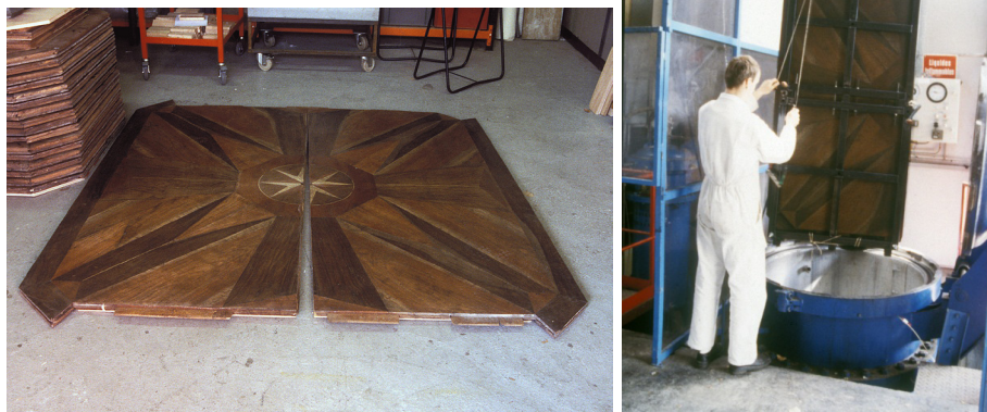
FIG. 17.3. Stânga: un exemplu de panou de parchet înainte de tratamentul de consolidare; dreapta: impregnarea unor panouri de parchet.
