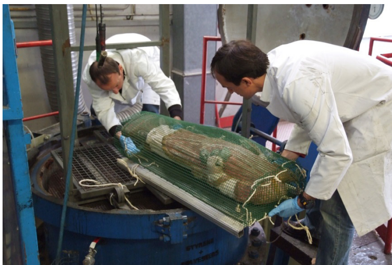
FIG. 16.3. Impregnarea cu rășină într-un recipient folosind vid/presiune.
