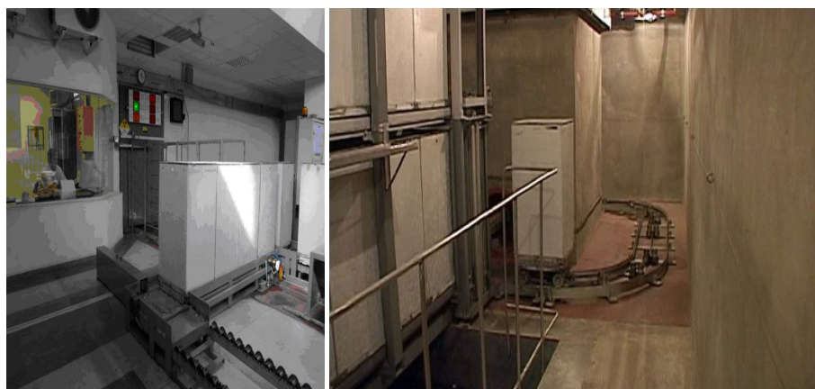
FIG. 15.4. Conveierul cu cutii al IRASM; stânga: în depozit; dreapta: în camera de iradiere
