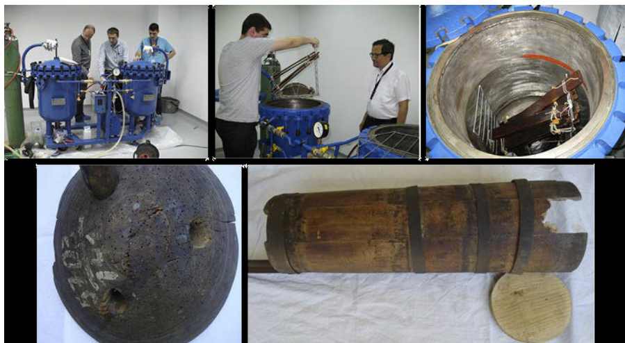
FIG. 21.9. Imagini de la prima serie de experimente de consolidare prin iradiere la IRASM a unor artefacte poroase cu asistența specialiștilor ARC-Nucléart.
