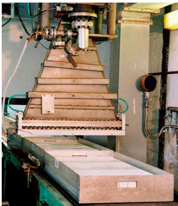
FIG. 20.1. Conveierul și cutiile de aluminiu din acceleratorul de electroni al Institutului de Chimie și Tehnologie Nucleară (INCN), Varșovia, Polonia.
