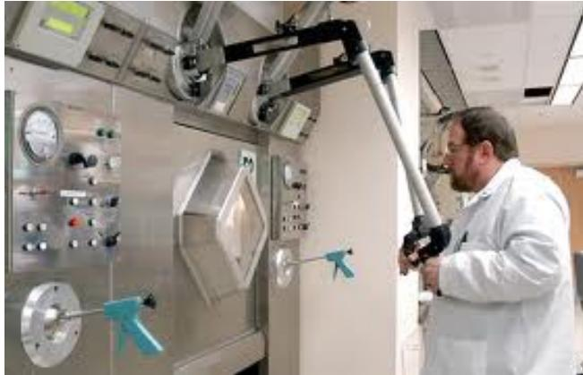
Centrul va fi utilat cu celule fierbinti si module de sinteza automate pentru prepararea radiofarmaceuticelor pentru PET in conditii de RBPF (GMP)
