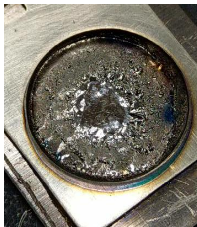
Figura 4. Tinta de ^{13}\text{C} dupa iradiere cu fascicul de ^{16}\text{O} la \approx 1.1 \mu\text{A} .
