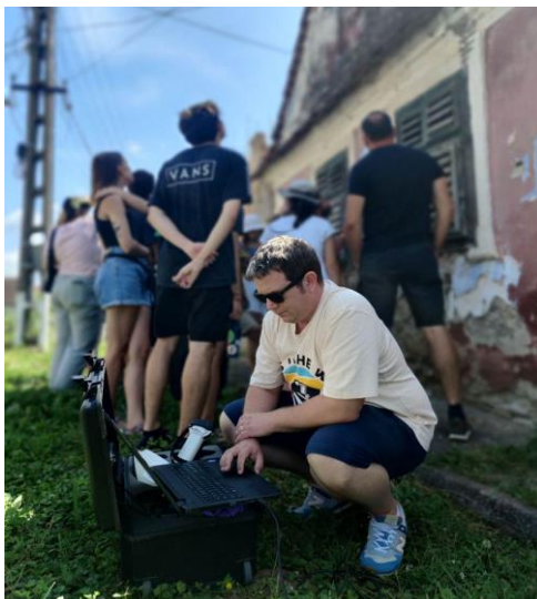
Spectrometrul portabil cu fluorescență de raze X Bruker Tracer 5i utilizat la analiza unor pigmenți prezenți în tencuiala caselor albastre de la Șona, Brașov
