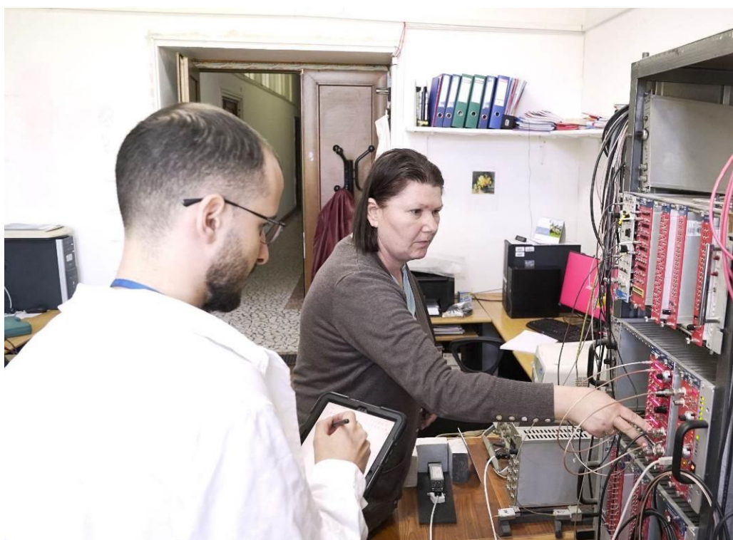
Structura experimentală pentru determinarea eficienței de detectare și a rezoluției energetice pentru cristalele de CsI(Tl) și NaI(Tl)
