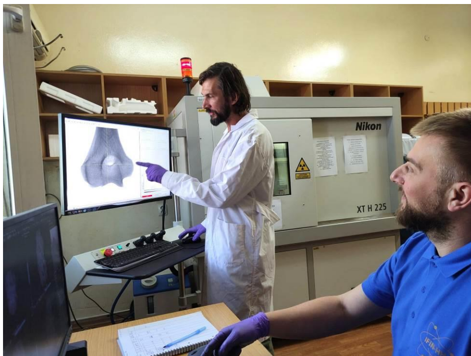
Instalația de tomografie computerizată cu raze X Nikon XTH225
