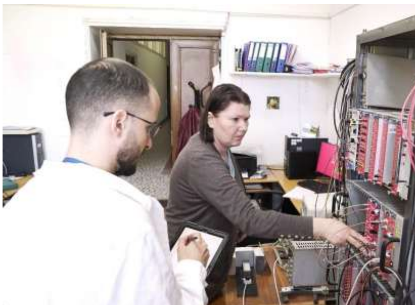
Structura experimentală pentru determinarea eficacității de detectare și a rezoluției energetice pentru cristalele de CsI(Tl) și NaI(Tl)
