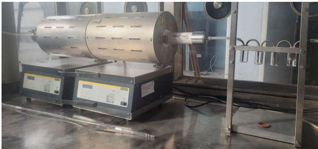
Instalația de Calcinare/Combustie Totală
