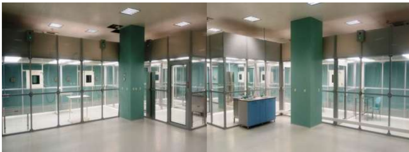
Ansamblul de Camere Curate Modulare Mobile/Movibile Reconfigurabile în configuratia de baza
