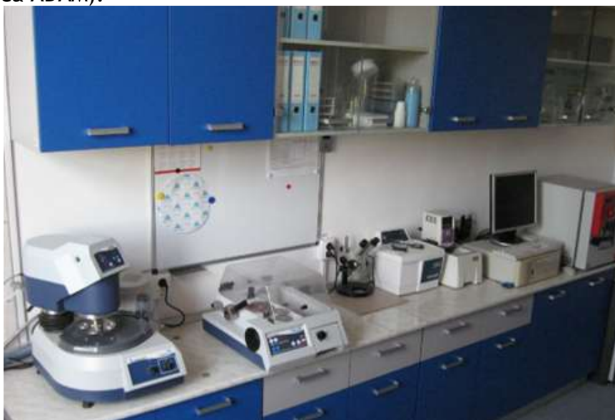
Echipamentele de tăiere, șlefuire și pregătire a probelor în vederea analizării cu microscopul de forță atomică
