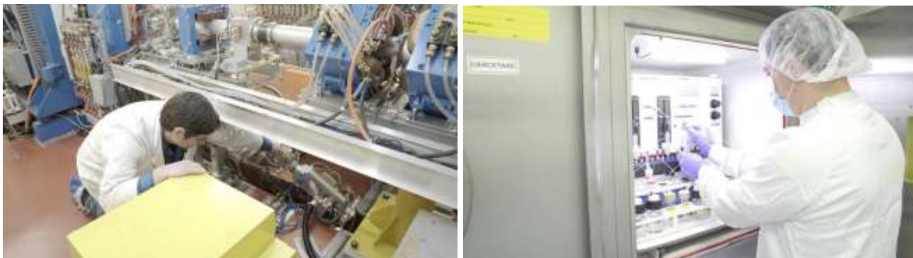
Sistem de iradiere cu protoni și post-procesare radiochimică a țintelor solide
