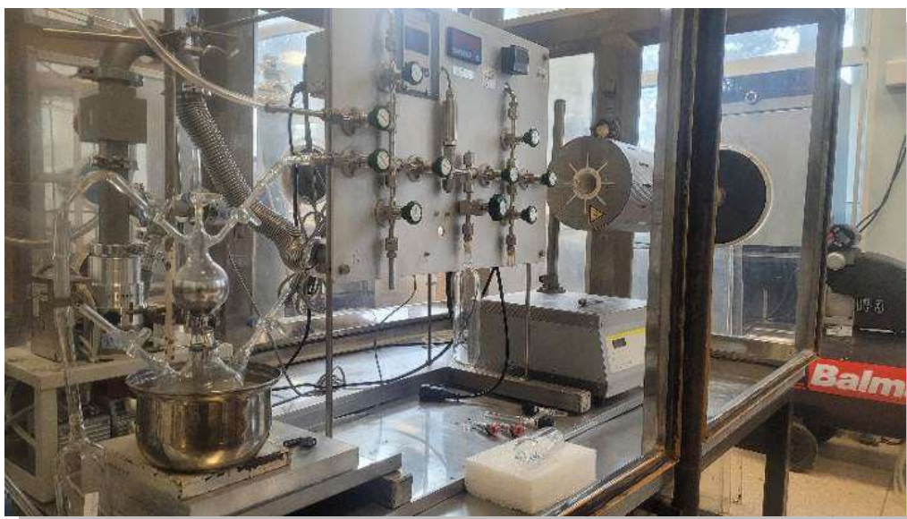
Instalația de vid și manipulare amestecuri gazoase ce conțin tritium
